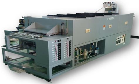
本炉は精密な温度制御の状態において処理物をN2雰囲気中において線材の焼鈍する目的として使用されます。
