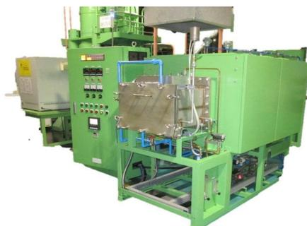
炉芯管内にセットされた処理物をN<sub>2</sub>+H<sub>2</sub>雰囲気中で焼成することを目的とします。
