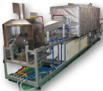
本炉は精密な温度制御の状態において処理物を各種雰囲気中で焼成する事を目的とした連続式メッシュベルト炉です。
