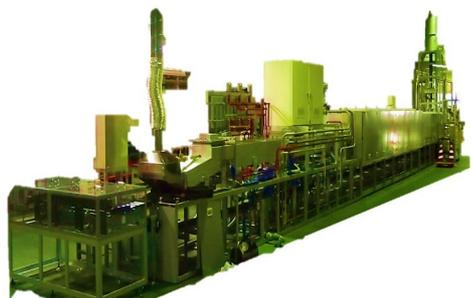
本炉は精密な温度制御の状態において処理物を各種雰囲気中で焼成する事を目的としています。
