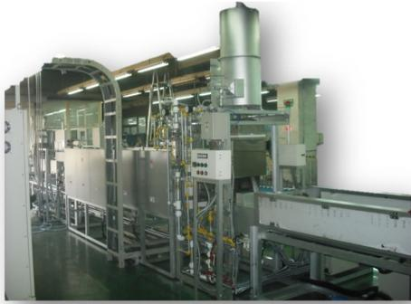
本炉は精密な温度制御の状態において処理物を各種雰囲気中で焼成する事を目的としています。
