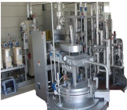
本炉は精密な温度制御の状態において処理物をスチーム中で黒化処理する事を目的として使用されます。
