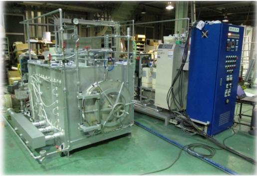
精密な温度制御の状態において、銅材の水蒸気雰囲気中での熱処理する事を目的としています。
