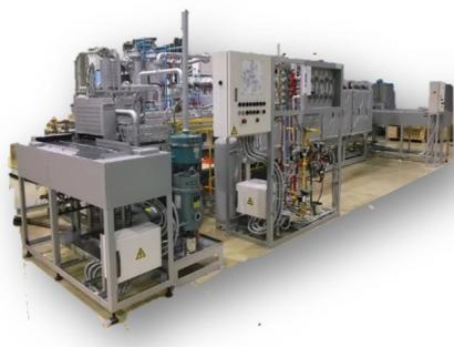
本炉は精密な温度制御の状態において処理物を各種雰囲気中で焼結する全自動プッシャー炉です。
