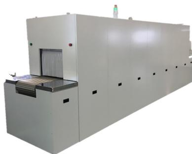
精密な温度制御の状態に於いて、大気雰囲気中で鑄鉄を連続的に紛体塗装の前処理として予熱処理を目的として使用されます。
