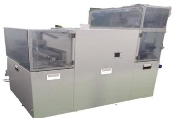
大気雰囲気中に治具にセットされた処理物を連続的に硬化させることを目的として使用されます。
