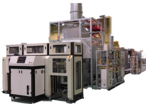
精密な温度制御の状態において処理物を各種雰囲気中で焼結することを目的とした連続式メッシュベルト炉です。
