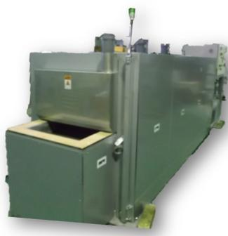
本炉は大気雰囲気中にて製品を連続的に熱処理することを目的とします。
