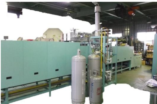
Fe系焼結品（含油）のスチーム雰囲気中で表面の黒化処理を行うことを目的としています。
