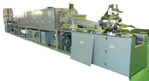
精密な温度制御の状態において処理物をRX雰囲気中で焼成する目的としています。
