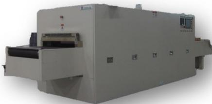
精密な温度制御状態の大気雰囲気中での金属材料の酸化処理を目的としています。
